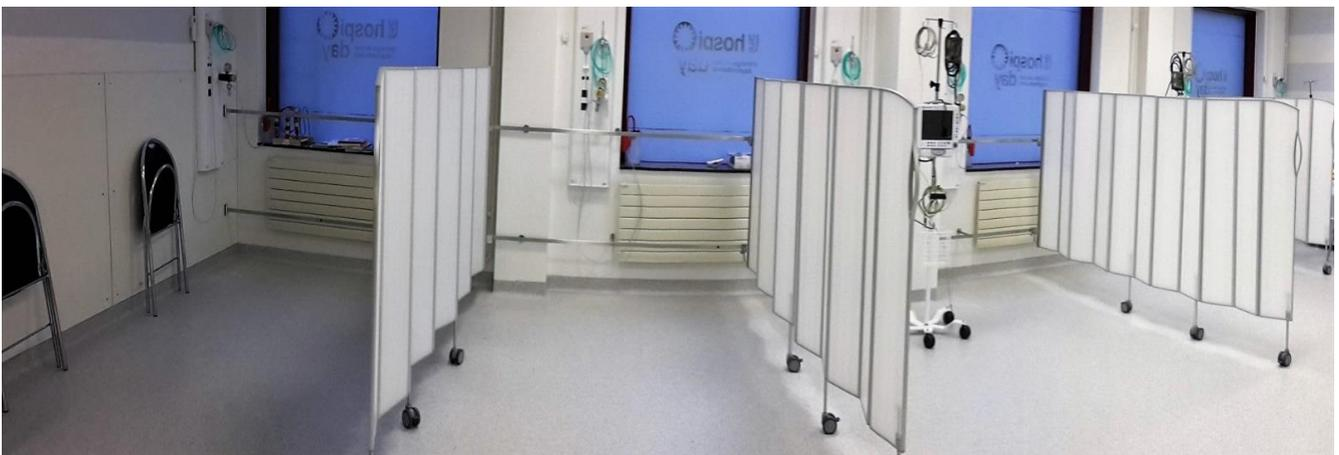
*Testopstelling van een verlengscherm van 0.75mt en 1.00mt in combinatie met een vouwschermen. Twee test hoogtes m.n 1.45mt en 1.65mt. Hiermee wordt naar een in de breedte ruimte besparende fixatie oplossing gestreefd die de controle apparatuur niet hindert.*
