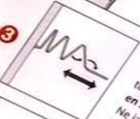
Grâce au système breveté charnières à mémoire, les sections pliantes tournent en zigzag. Une disposition en zigzag augmente la stabilité. Ne jamais forcer ou essayer de tirer le paravent en ligne droite.
